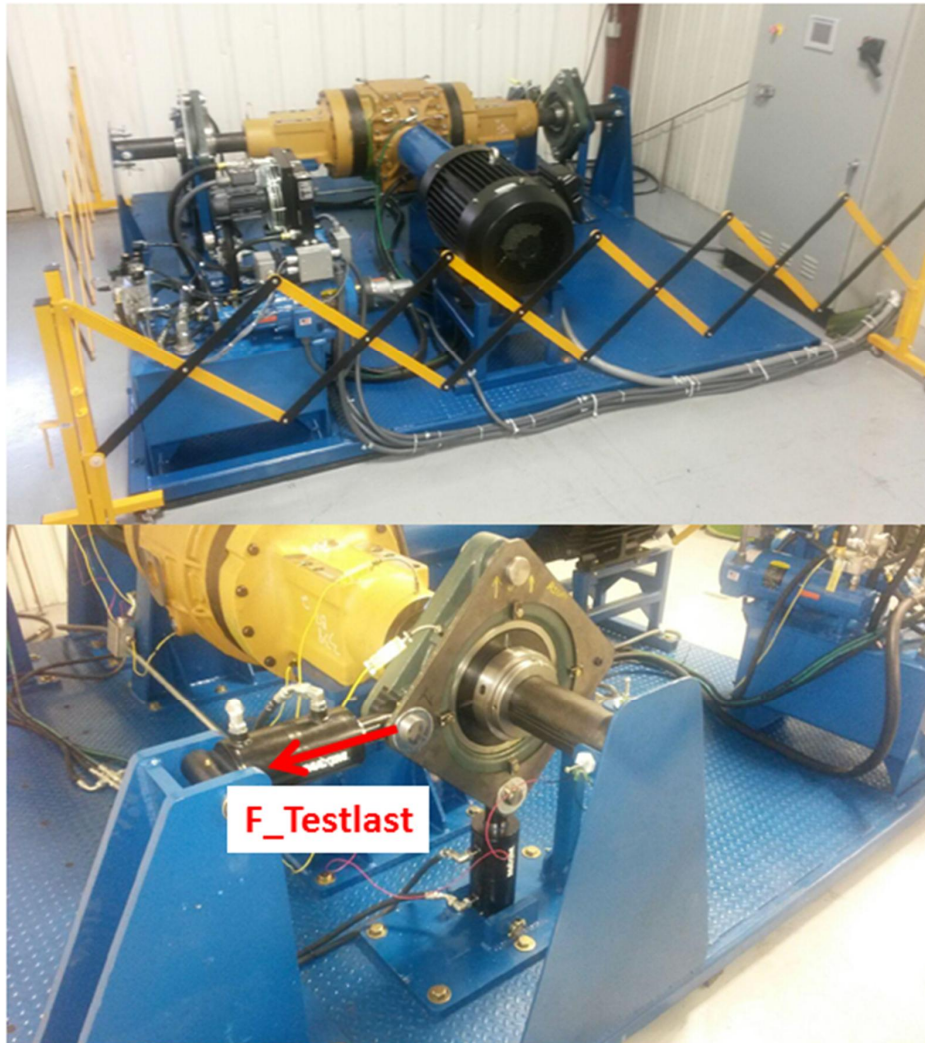
Abbildung 6-13: Aufbau einer Biegeumlaufprüfung von Traktor-Hinterachswellen
