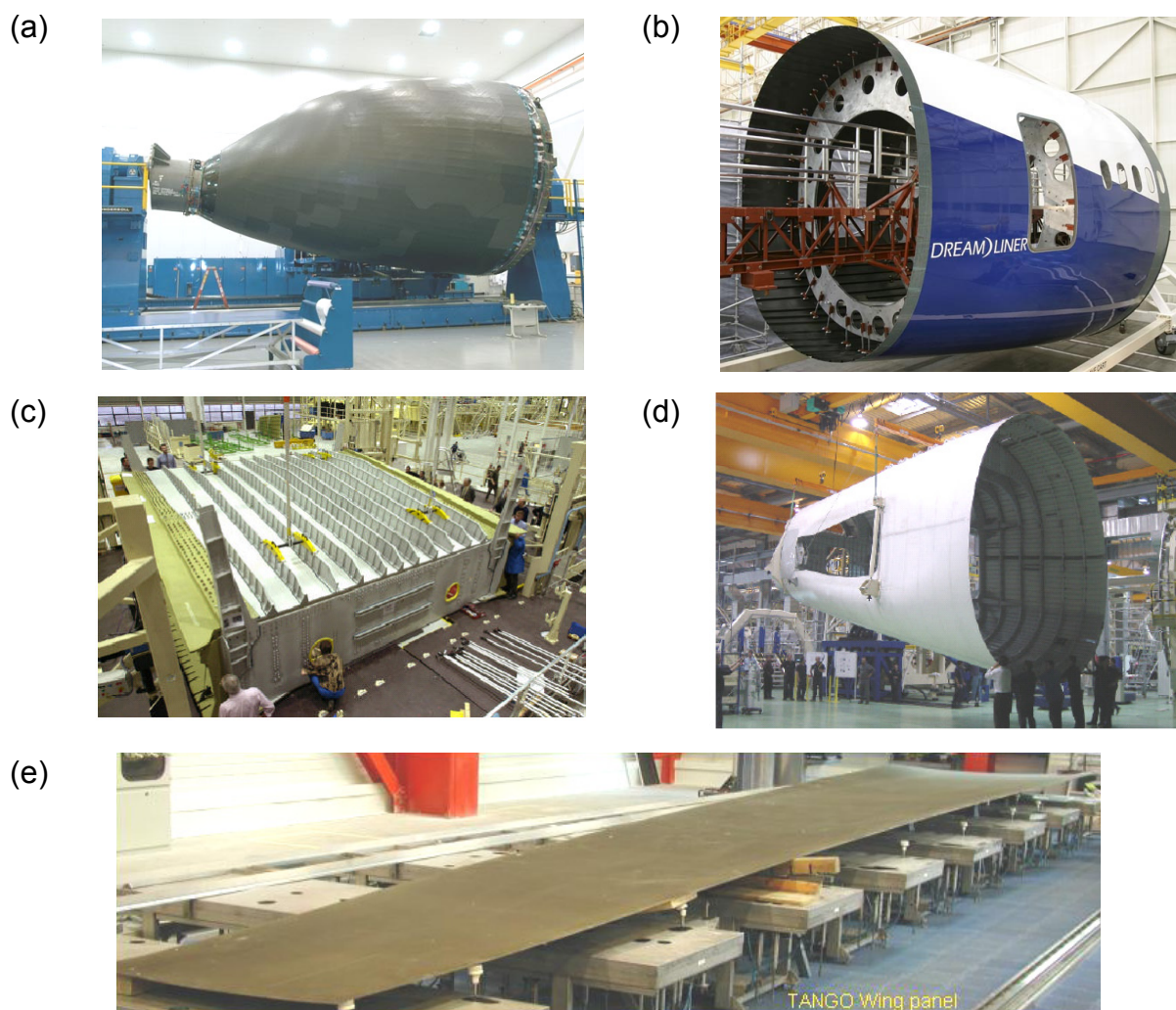
Abb. 1.2: CFK-Flugzeugstrukturen: (a) Flugzeugnase und (b) Rumpfsegment Boeing 787 [13], [14], (c) Center Wing Box und (d) Sektion 19 Airbus A380 [15], (e) Studie einer Flügelunterschale [4]
