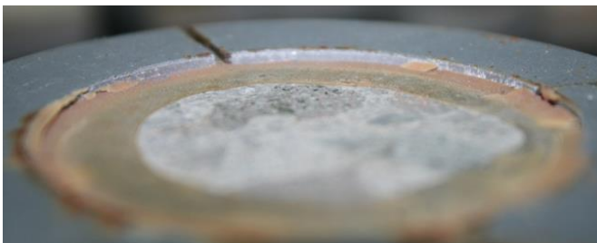
Typisches Bruchbild einer Schubprobe Hilti HIT RE 500 nach 18 Mo. Freibewitterung
