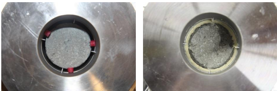
Abbildung 2-6: (links) Blick auf die Unterseite eines verkeilten Betonzylinders, (rechts) frisch geklebte Probe
