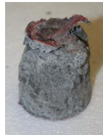
Typisches Bruchbild einer Schubprobe Hilti HIT RE 500, ungealtert
