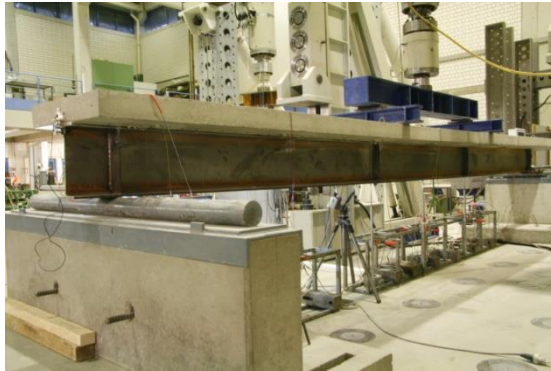
Abbildung 4-19: Versuchsaufbau eines Vier-Punkt-Biegeversuchs
