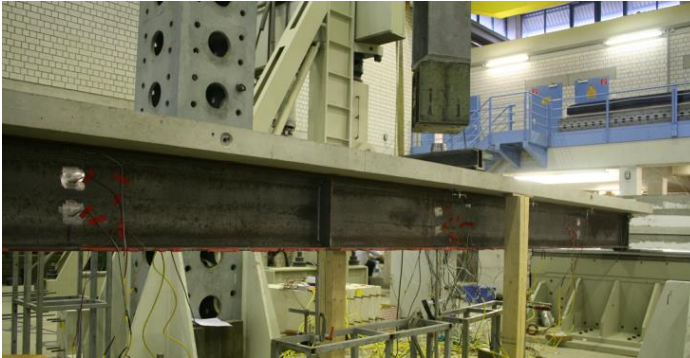
Abbildung 4-13: Versuchsaufbau der dynamischen Schwingungsprüfung
