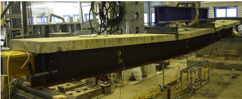
Abbildung 4-20: Verbundträger nach der Versuchsdurchführung
