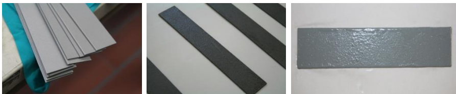
Abbildung 2-9: (links) Proben ohne Beschichtung, (mittig) beschichtete Proben, (rechts) Proben nach der Entnahme aus der Salzsprühnebelkammer
