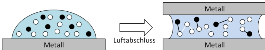
Abbildung 1-8 Aushärtung eines anaeroben Klebstoffes (ThreeBond Europe)
