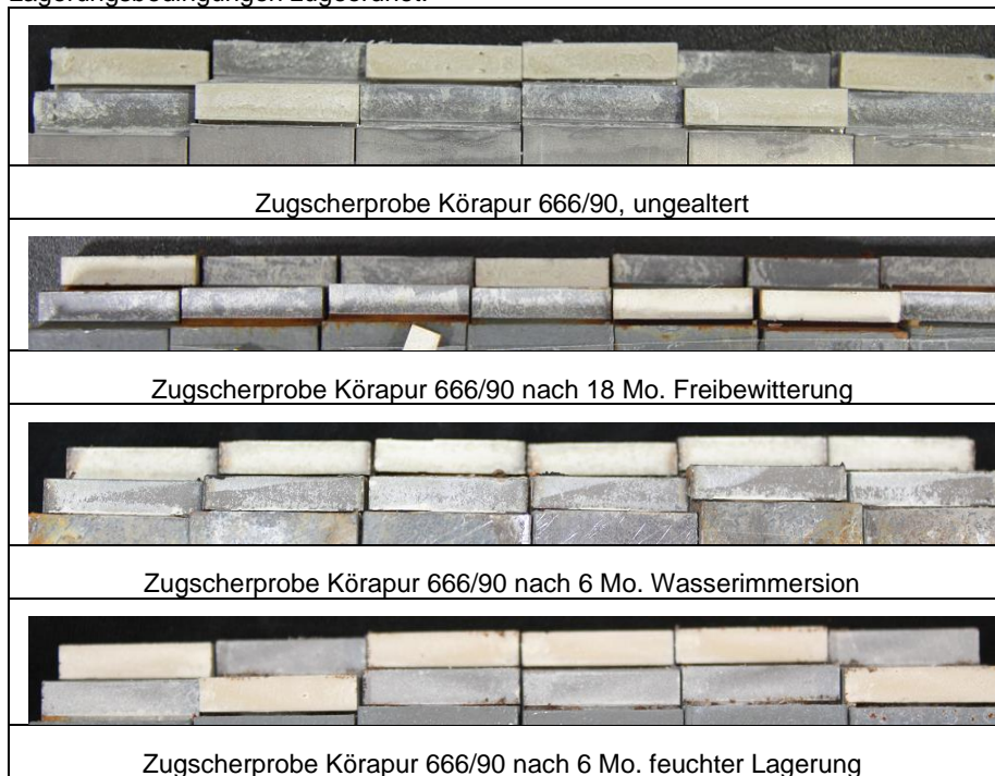
Abbildung 3-15: Bruchbilder der Körapur 666/90 Zugscherproben
