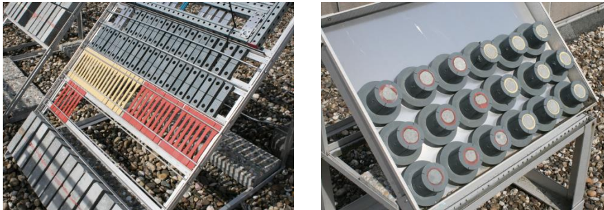
Abbildung 2-7: Kleinprobenlagerung zur natürlichen Alterung
