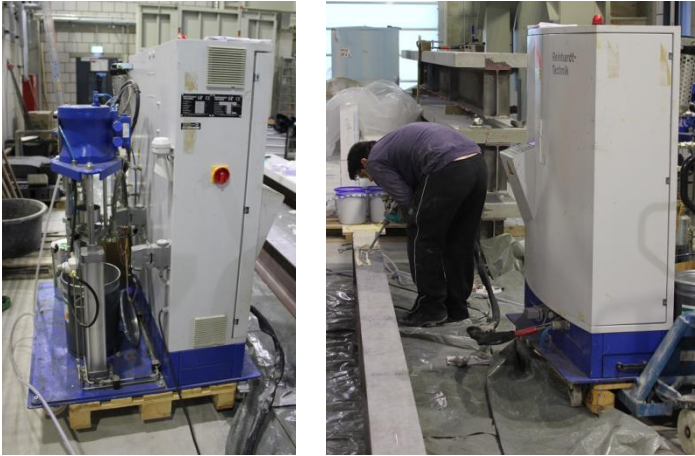
Abbildung 4-6: (links) Pneumatische Misch- und Dosieranlage der Firma KÖmmerling Chemie, (rechts) Klebstoffauftrag
