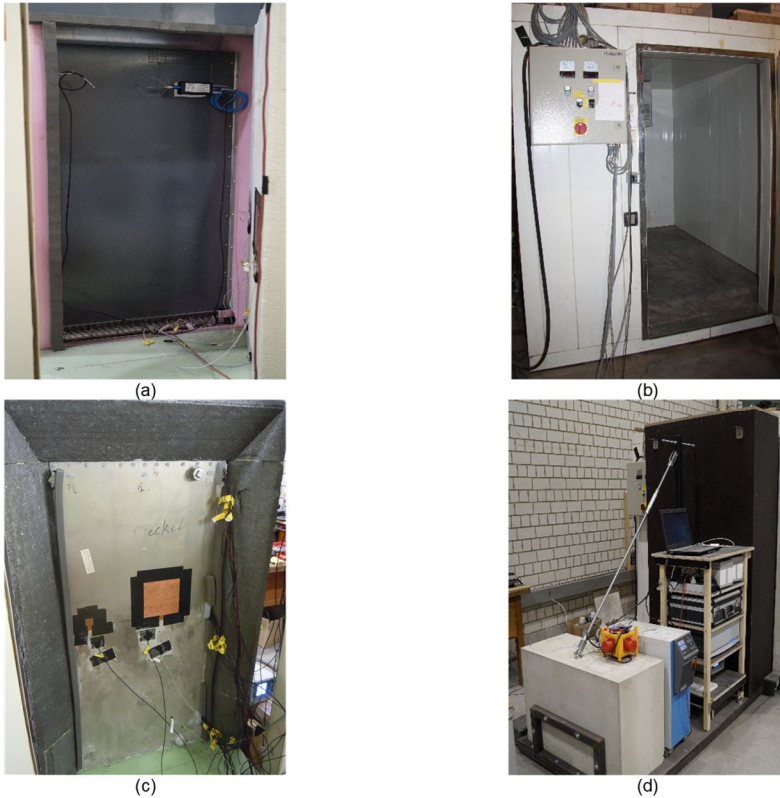
Abb. 5.7: (a) Heat Box; (b) Klimakammer; (c) und (d) Versuchsaufbau
