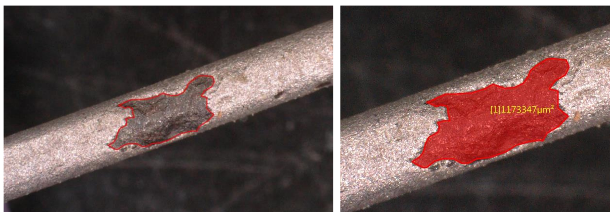
Abbildung 5-16: Analyse und Quantifizierung der korrosionsgeschädigten Flächenanteile der ausgebauten Stahlanoden
