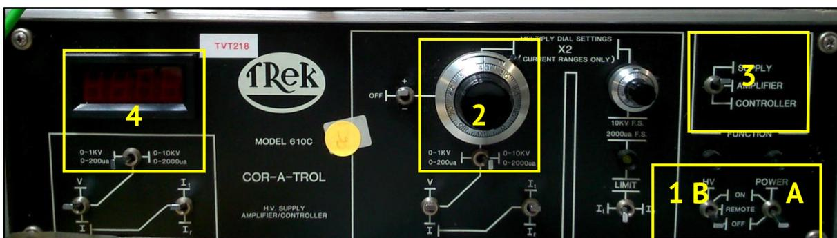
Abbildung 56: Hochspannungsgenerator Trek 610C
