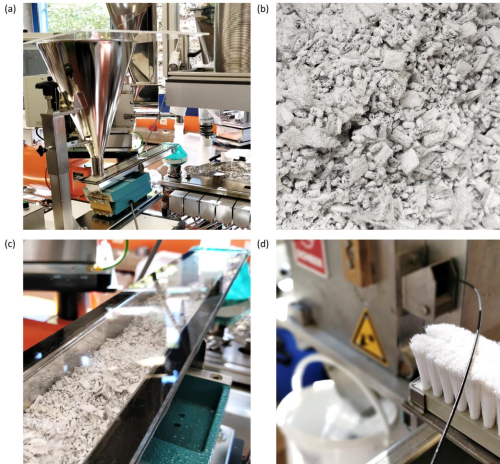
Abbildung 51: Ablauf des Herstellprozesses: (a) Staubschutzvorrichtungen an Schwingförderantrieb und Hauptdosierung; (b) Vorgemischte Einzelkomponenten, wobei die \text{Mg}(\text{OH})_2 -Partikel besonders gut an den Schnitffasern haften und somit auch beim (c) Transport über die Dosierbahn keine Entmischung stattfindet; (d) Extrudierter Strang und Zuführung zum Granulator.
