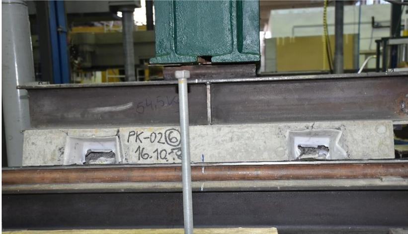
Abbildung B.8-8: Nach dem Bruch liegen die Stahlschlaufen auf dem Auflager. Die Last musste auf die Bereiche zwischen und neben den Aussparungen abgetragen werden. Ausschließlich die untenliegende Carbonbewehrung verankert die im Bauteil auftretenden Zugkräfte.
