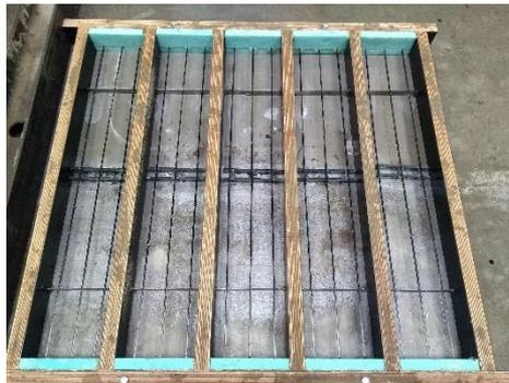
Abb. 3-30: Bewehrte Schalung für Verankerungsversuche gem. Abb. 3-29
