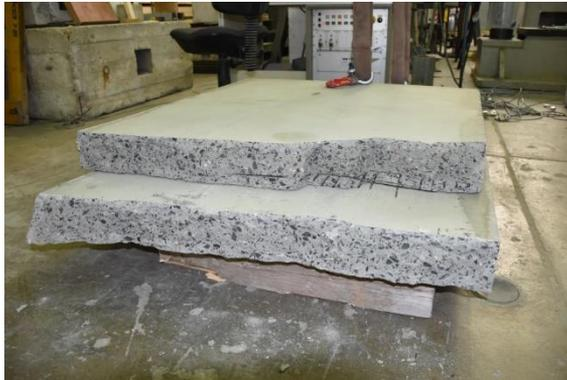
Abb. 3-43: Zwei halbe Platten nach Reißen der Bewehrung
