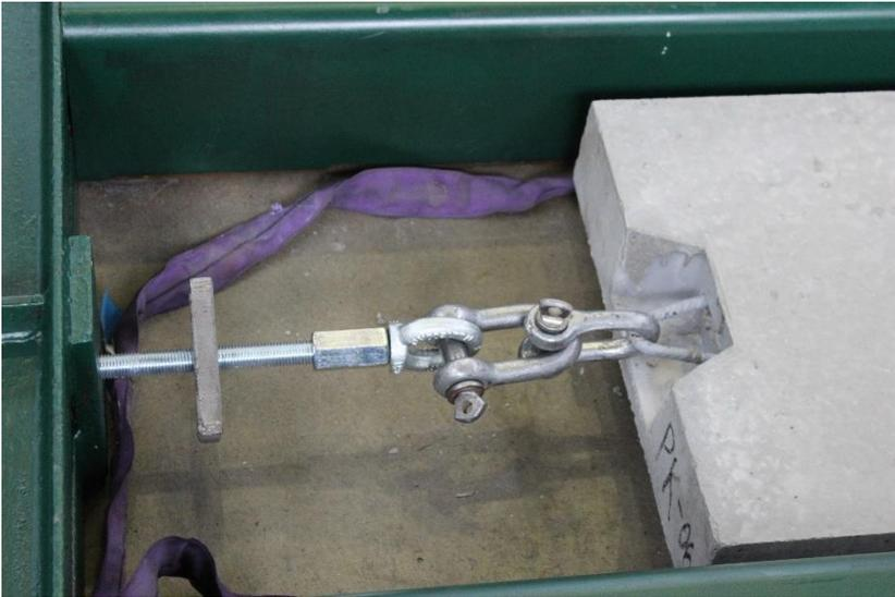
Abbildung B.12-3: Plastische Verformung der Stahlschlaufen
