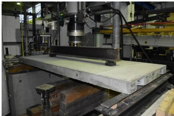
Abb. 3-59: Probekörper im Versuchsstand mit punktueller Lasteinleitung
