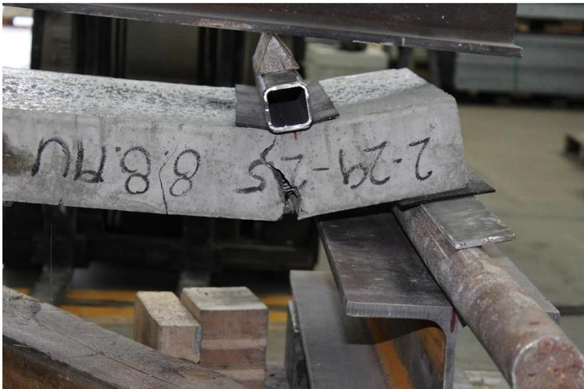
Abbildung B.5-7: Detailaufnahme im Bereich des Risseinleitungsblechs
