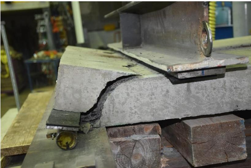
Abbildung B.8-7: Ausgebildeter Druckbogen zum Auflagerrand hin
