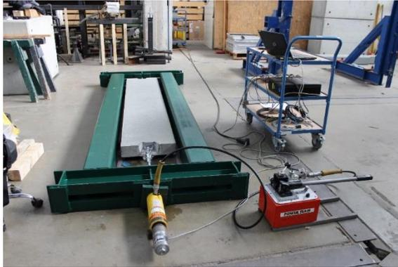
Abb. 3-69: Versuchsaufbau Übergreifungsversuche
