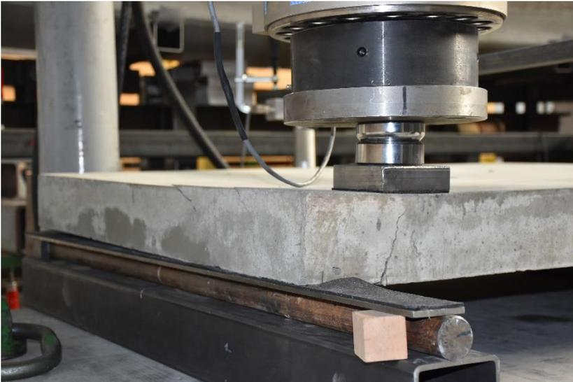
Abbildung B.11-1: Traglastzustand mit Rissbildung (Versuch (PL-R-02))
