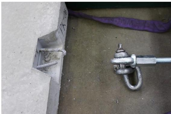
Abb. 3-70: Typisches Versagensbild der Übergreifungsversuche
