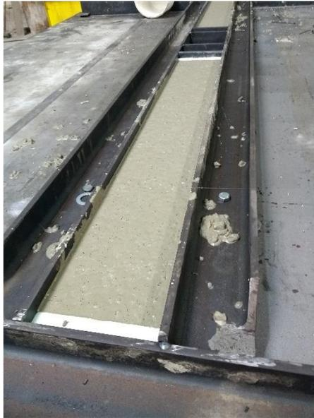
Abbildung B.5-3: Frisch betonierter Versuchskörper
