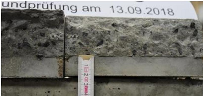
Abbildung B.5-9: Prüfen der Betondeckung nach Bruch
