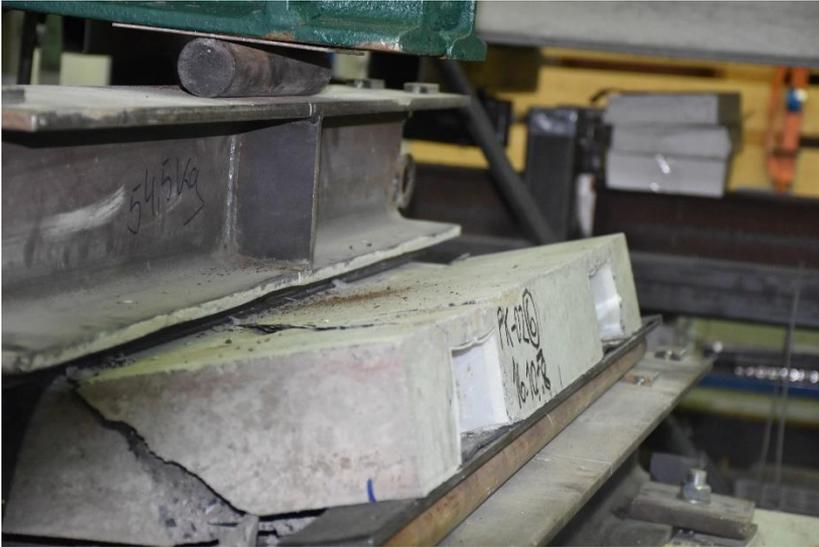
Abbildung B.8-6: Bruchbild im Schubversuch
