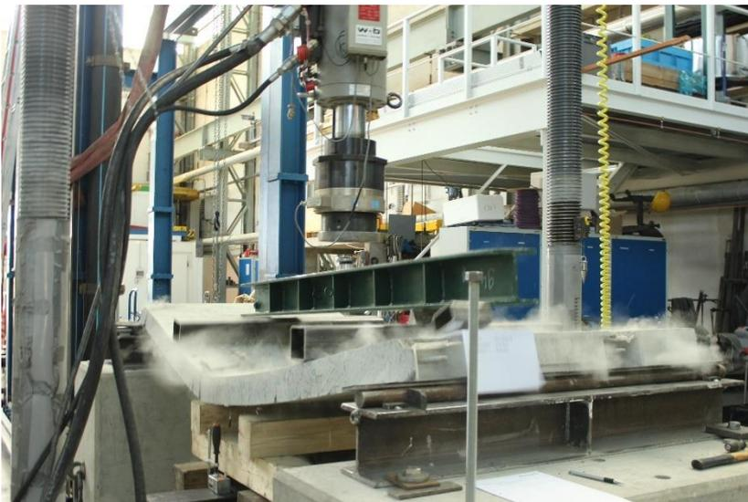
Abbildung B.7-4: Decke beim Biegeversagen
