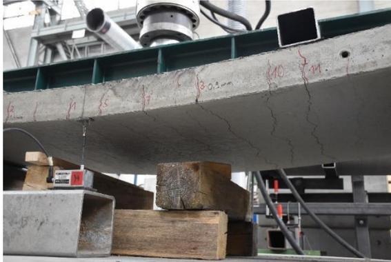
Abb. 3-42: Abgeschlossenes Rissbild, keine Abplatzungen (Delaminieren) bei großen Verformungen
