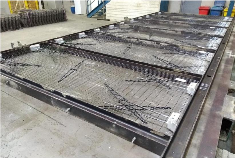
Abbildung B.6-1: Schalung der Versuchskörper mit Carbonbewehrung und Stahlschlaufen
