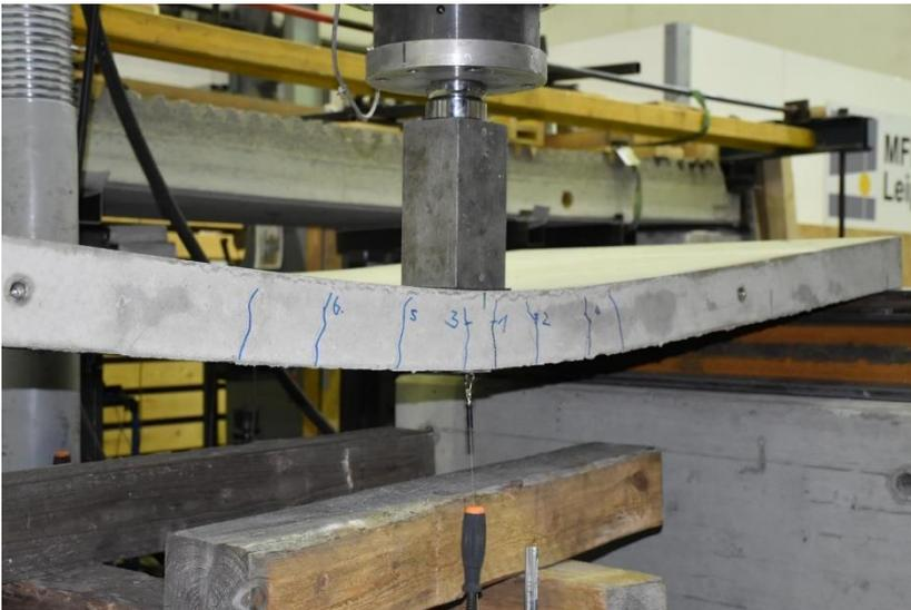
Abbildung B.10-2: Verformung der Deckenplatte
