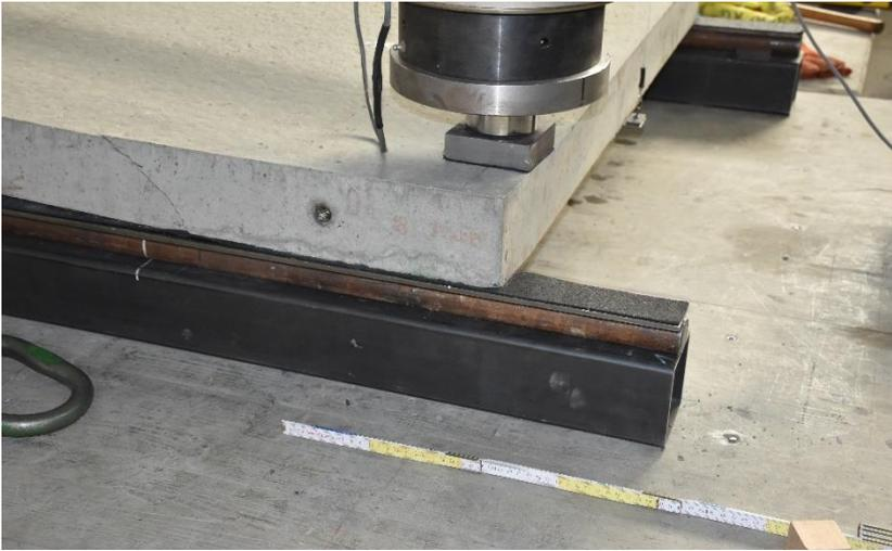
Abbildung B.11.3: Lasteinleitung und Rissbild (Versuch PL-R-04)
