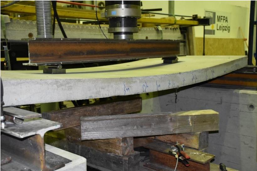
Abbildung B.9-1: Prüfung mit angezeichnetem Rissbild
