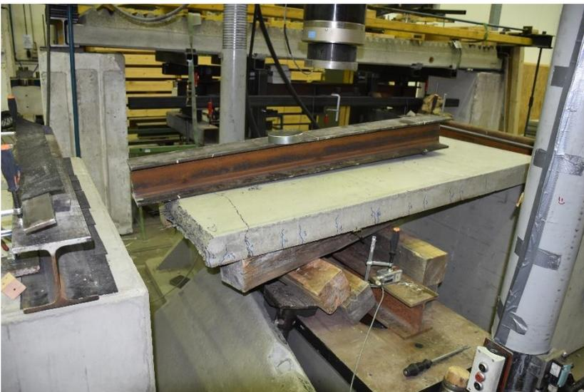
Abbildung B.9-2: Bruchbild beim Biegeversagen
