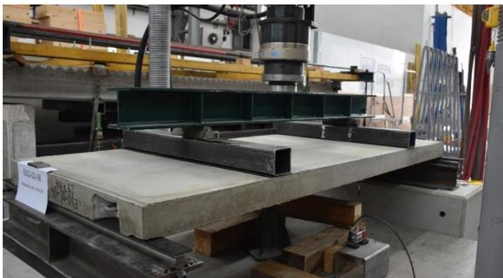
Abb. 3-39: Versuchsaufbau, Deckenplatte im Prüfstand
