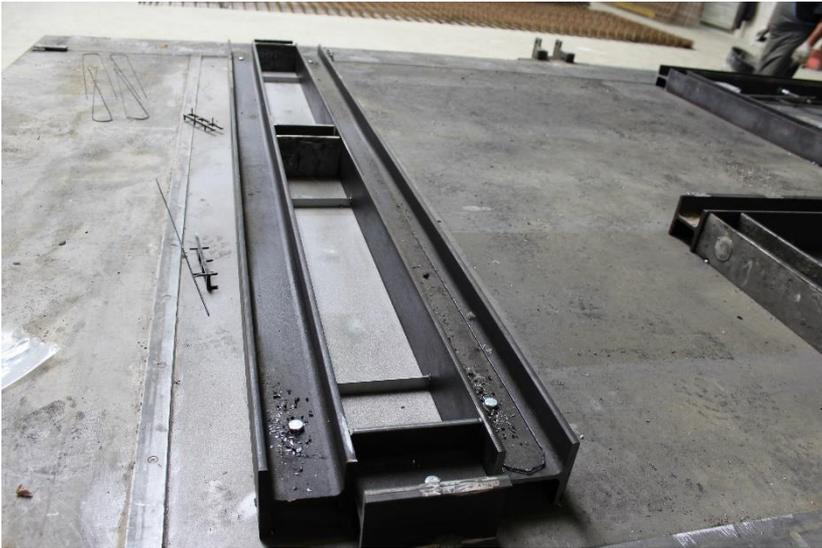
Abbildung B.5-1: Schalung mit Risseinleitungsblechen
