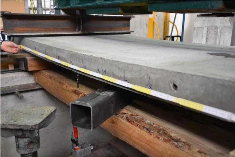
Abbildung B.8-4: Rissdokumentation im Schubversuch
