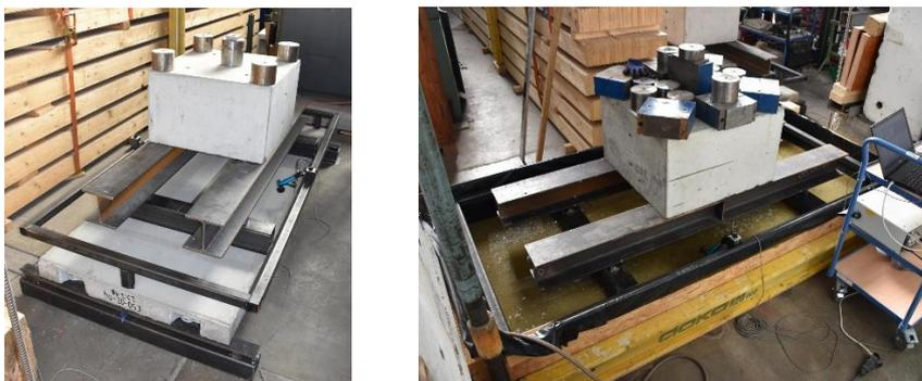
Abb. 3-48: Langzeitversuch in trockener und nasser Umgebung
