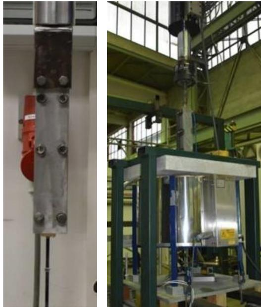
Abb. 3-22: Eingeklebter Roving (links) und Versuchsaufbau mit Ofen (rechts)
