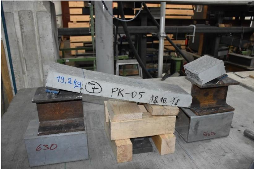
Abbildung B.5-8: Versuch nach erreichter Traglast: Bewehrung gerissen
