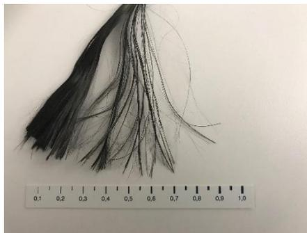
Abbildung 2-1: Roving aus 98000 einzelnen Filamenten<sup>5</sup>
