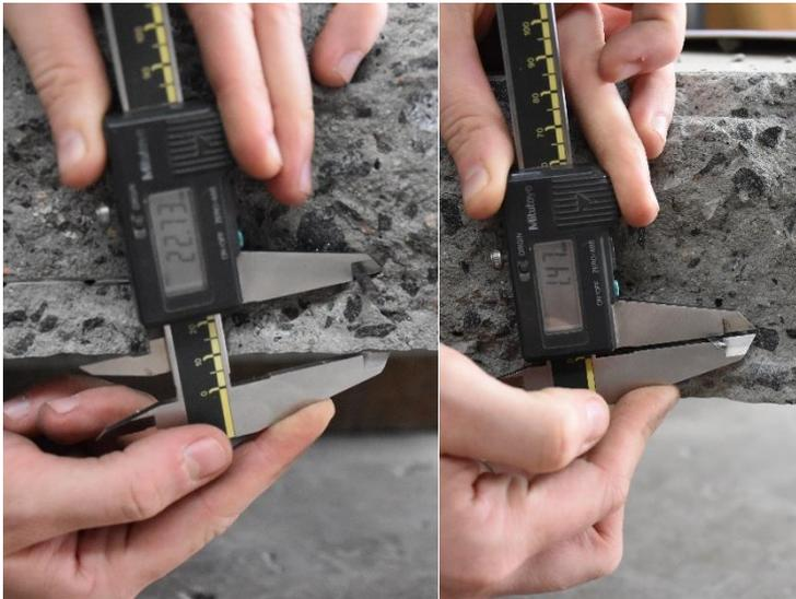
Abbildung B.7-5: Nachprüfen der Betondeckung und Messung der Rovingdicke inklusive Tränkungsmaterial
