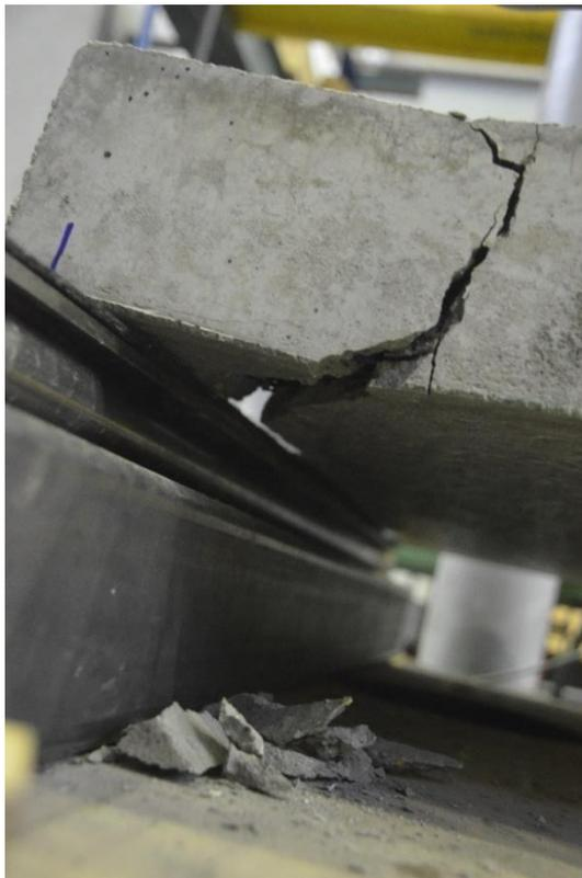
Abbildung B.11-4: Traglastzustand, Bruchbild (Versuch PL-R-05)
