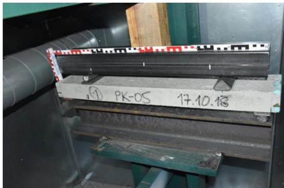
Abb. 3-37: Verankerungs-Dauerstandversuch in Klimakammer
