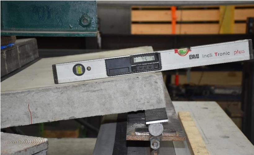
Abbildung B.7-3: Große Endtangentialverdrehung vor Erreichen der Traglast
