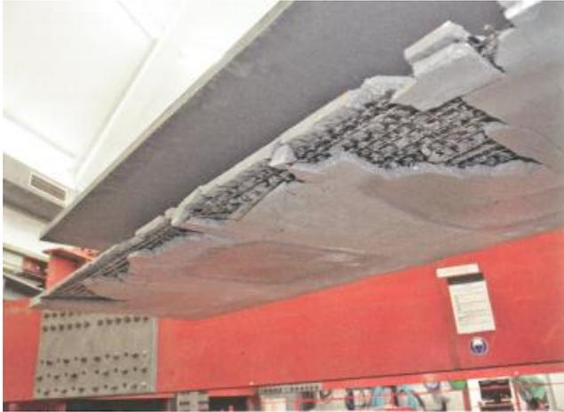
Abb. 3-28: Großflächige Betonabplatzungen (Bild aus /Prei18/)
