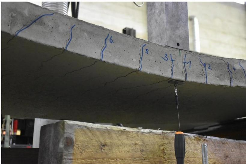
Abbildung B.10-3: Rissentwicklung Untersicht der Deckenplatte
