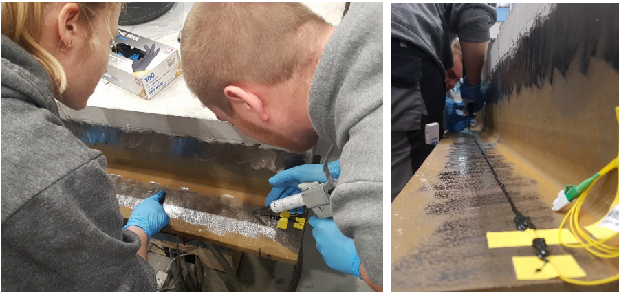
Abb. 7.10: Applizierung der Glasfaser: Positionierung (links) und Aufkleben (rechts)
