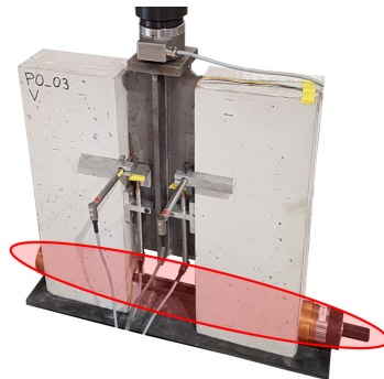
Abb. 3.6: Messung der Kraft in der Querkzugstange
