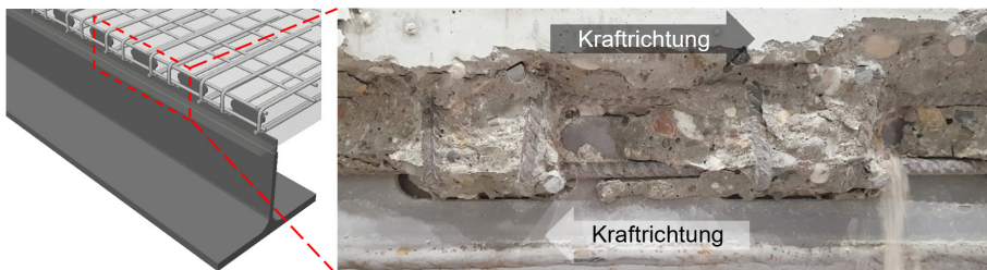
Abb. 1.1: Verbundträger mit oberflächennaher Verbunddübelleiste (links) und dessen typisches Versagensbild Kantenbruch (rechts)
