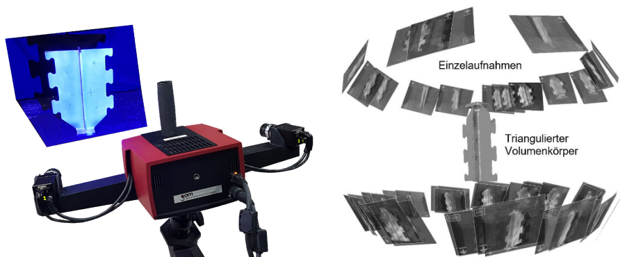
Abb. 3.7: Optisches 3D Messsystem: Bildaufnahme durch das Stereokamerasystem (links) und Berechnung eines Volumenkörpers aus den Einzelbildern (rechts) [Gom 2017]
