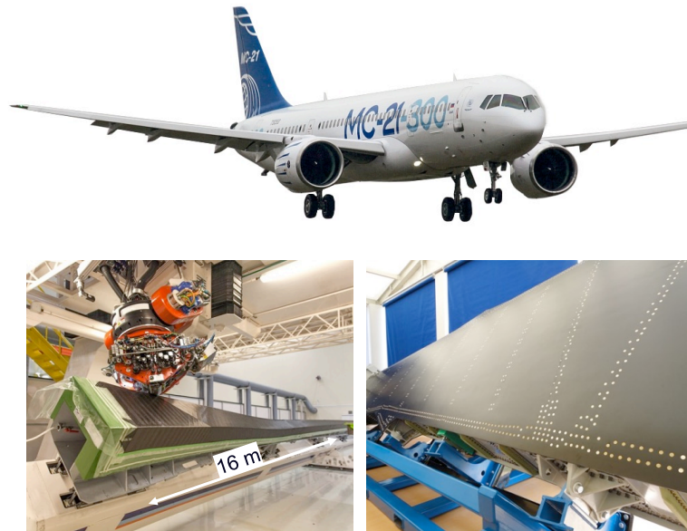
Abbildung 1.2: Oben: Irkut MC-21 [14], Links unten: Ablage einer Flügelschale im DFP-Verfahren [12], Rechts unten: Fertiggestelltes Bauteil [12]
