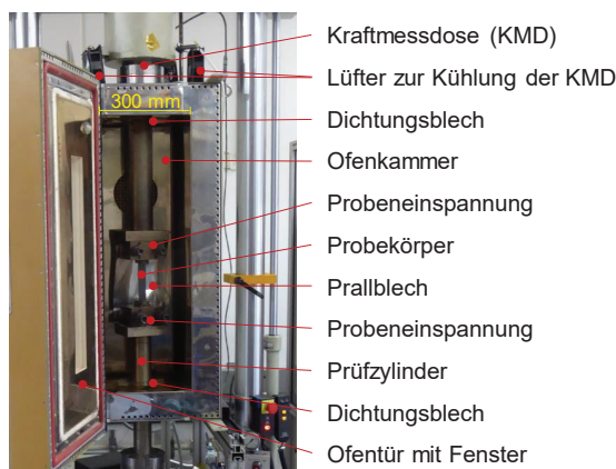
Abbildung 5.2: Versuchsumgebung für temperierte Zugversuche
