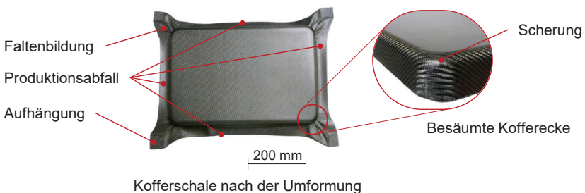
Abbildung 1.1: Umgeformtes Organoblech (Kofferschale) und prozessbedingte Effekte / Defekte.
