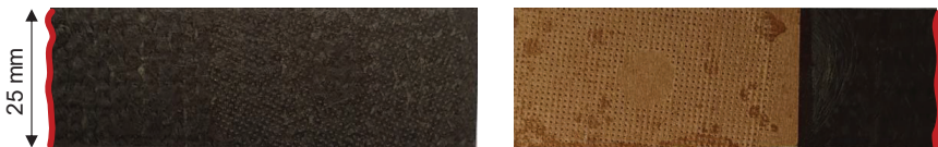
Abbildung 4.5: Zugprobekörper ohne (links) und mit Kraffteinleitungselement (rechts), nach der Prüfung
