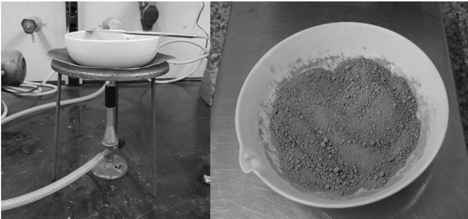
Abbildung 3-6: Verfahren 1 zur Wassergehaltsbestimmung in Anlehnung an den Darrversuch
