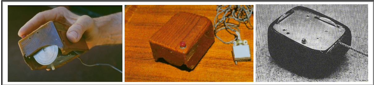
Abbildung 2-6 Die Original-Maus von Douglas C. Engelbart (1968)
