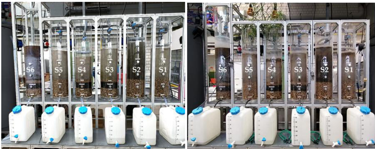
Abbildung 3-2: Kleintechnische Bodenfilteranlagen nach Inbetriebnahme mit Grauwasser (links) und nach über 500 Tagen Betrieb (rechts).
