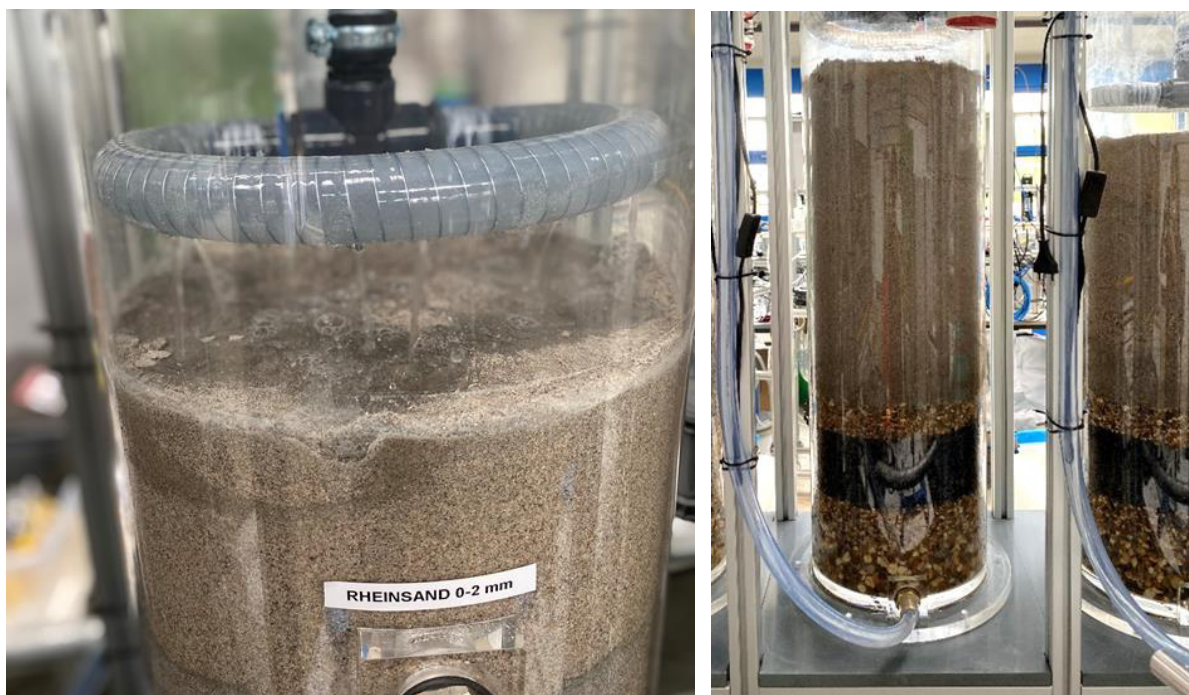
Abbildung 3-4: Beschickung von Grauwasser über den Zulaufverteiler in eine Vertikalfiltersäule mit Rheinsand als Filterschicht (links); Be-/Entlüftungsschlauch am Grunde des Filters (rechts).
