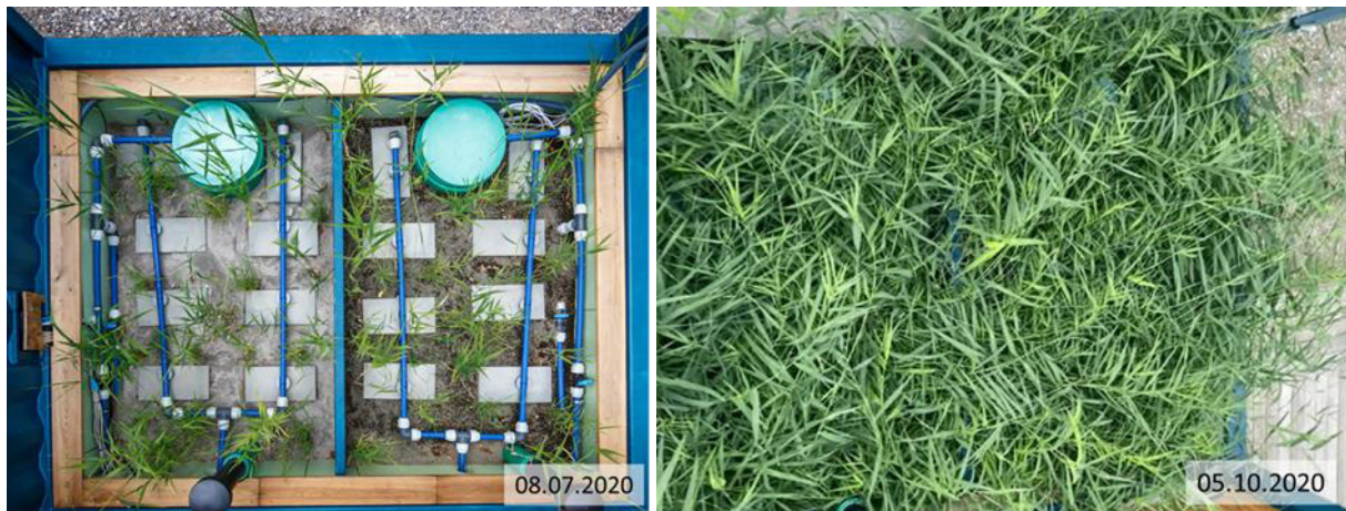
Abbildung 3-8: Rheinsand- (0 – 2 mm) und Lavasandbodenfilter (0 – 4 mm) im Pilotmaßstab bei Inbetriebnahme mit Grauwasser (links) und nach ca. 3 Monaten Betrieb (rechts). Foto: J. Rettig (2020)
