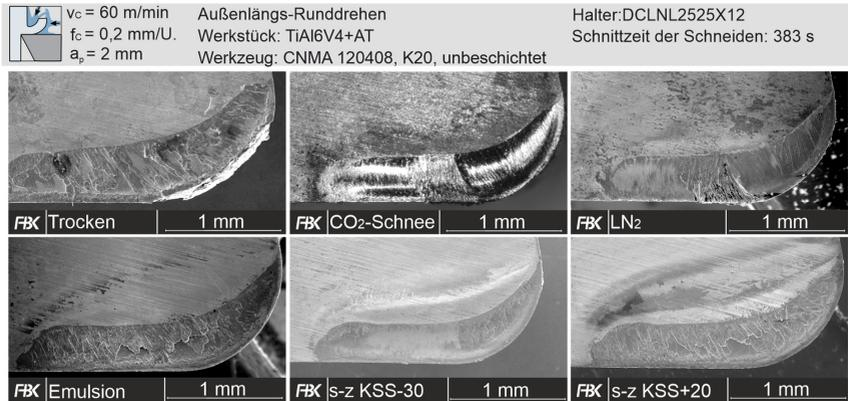
Abbildung 6-4: Qualitativer Vergleich des Kolkverschleißes beim Schruppen von TiAl6V4.
