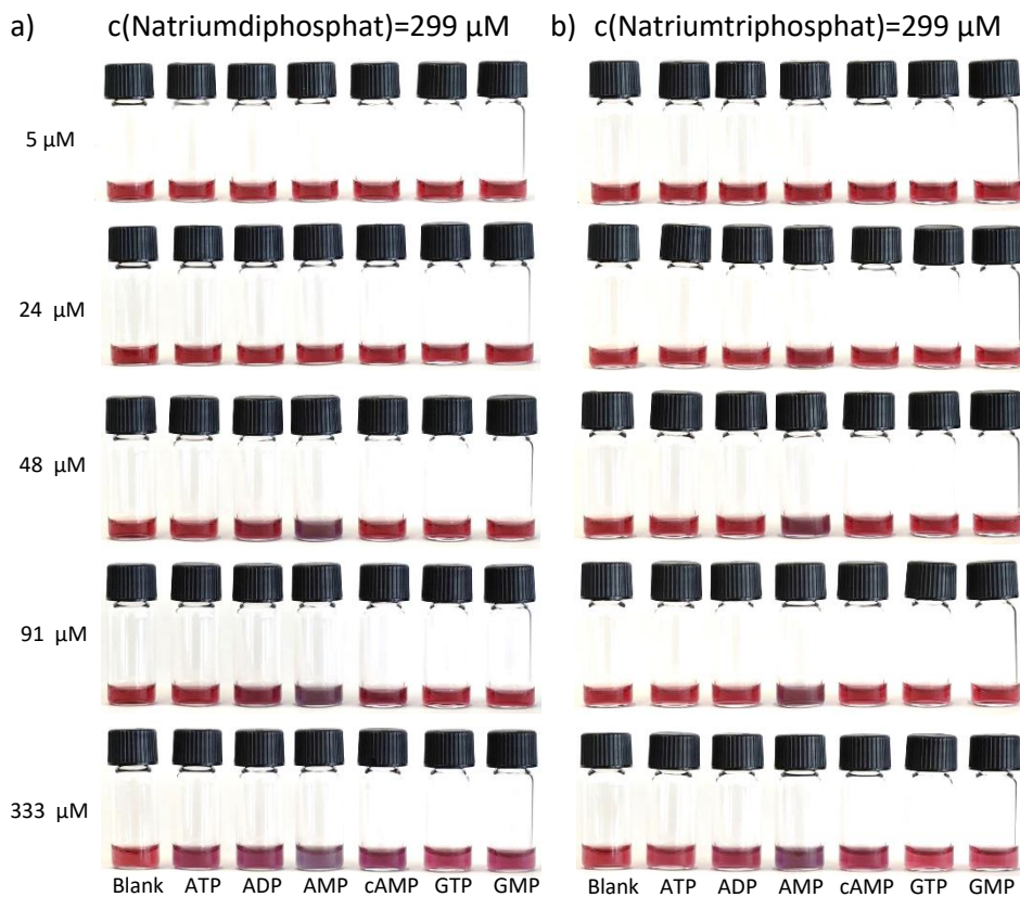
Abbildung 54 Lösungen von NP3 8 in Wasser/Methanol 1:2 (v:v) nach Zusatz von Zn(NO_3)_2 (50 \mu\text{M} ) und Natriumdiphosphat (299 \mu\text{M} ) (a) und Natriumtriphosphat (299 \mu\text{M} ) (b) nach Zugabe verschiedener Nukleotide in steigenden Konzentrationen. Alle Nukleotide wurden als Natriumsalze zugesetzt.
