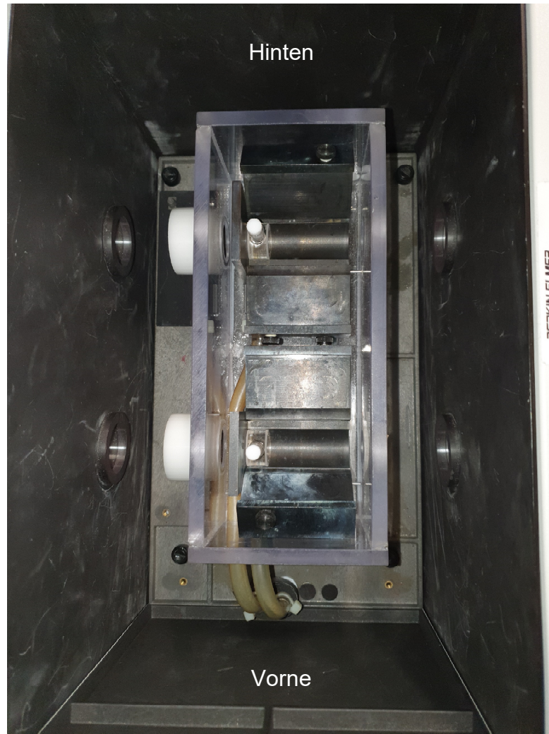
Abb. 3.8: Probenraum des Lambda 900 (von oben fotografiert) mit Referenzstrahlengang (hinten) und Probenstrahlengang (vorne) für die Doppelstrahltechnik (nach rechts Richtung Detektor). Die Küvetten für die Flüssigmessungen enthalten das reine Lösungsmittel (hinten) und die gelöste Probe (vorne).
