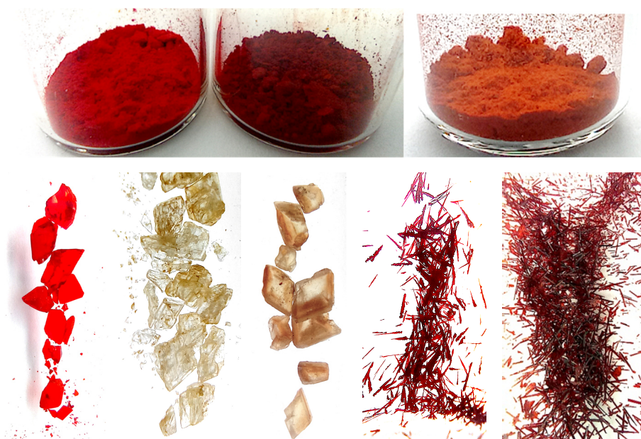
Abbildung 3: Fotografien der Produkte des Typs R CpMX 3 . Erste Reihe von links nach rechts: Cp h TiBr 3 1a , Cp h TiBr 3 1b und Cp l TiBr 3 5 in mikrokristalliner Form. Zweite Reihe von links nach rechts: Cp h TiBr 3 1a , Cp h ZrCl 3 2 , Cp h HfCl 3 3 , Cp h TiBr 3 1b und Cp l TiBr 3 5 in kristalliner Form.
