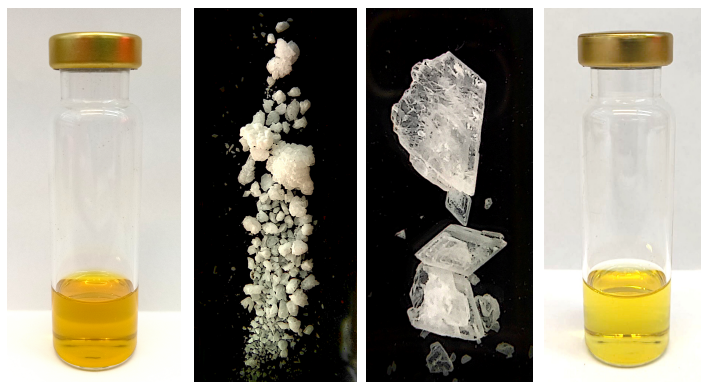
Abbildung 22: Fotografien der Produkte des Typs {}^R\text{CpM}(\text{OAc})_3 . Von links nach rechts: \text{Cp}''\text{Ti}(\text{OAc})_3 21a gelöst in Pentan, \text{Cp}''\text{Zr}(\text{OAc})_3 22 und \text{Cp}''\text{Hf}(\text{OAc})_3 23 in kristalliner Form sowie \text{Cp}'''\text{Ti}(\text{OAc})_3 21b gelöst in Pentan.
