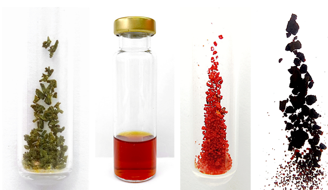
Abbildung 52: Fotografien der Produkte des Typs \text{R}^{\text{Cp}}\text{TiBr}_2(\text{TEMPO}) und \text{R}^{\text{Cp}}\text{TiBr}(\text{TEMPO})_2 . Von links nach rechts: \text{Cp}''\text{TiBr}_2(\text{TEMPO}) 44a in kristalliner Form und Komplex 44a gelöst in Pentan, \text{Cp}''\text{TiBr}(\text{TEMPO})_2 45 sowie \text{Cp}''\text{TiBr}_2(\text{TEMPO}) 44b in mikrokristalliner und kristalliner Form.
