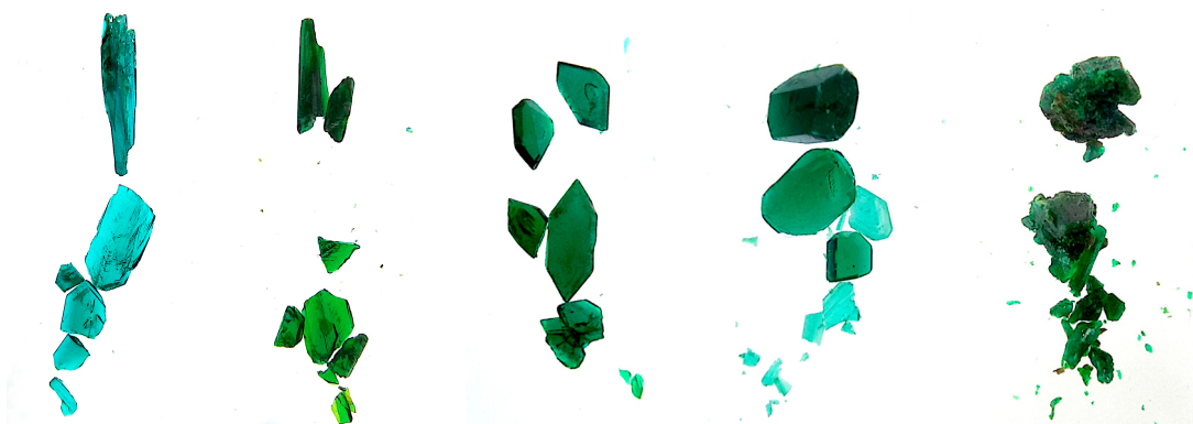
Abbildung 71: Fotografien der Produkte des Typs R CpTiBr_2(1,3\text{-dimethylimidazolidinon}) und R CpTiBr_2(\text{tetramethylharnstoff}) . Von links nach rechts: blaue Kristalle des Cp'''TiBr_2(1,3\text{-dimethylimidazolidinon}) 51a vor dem vollständigen Entfernen des Lösungsmittels und 51a in Form grüner Kristalle nach restlosem Entfernen des Lösungsmittels unter vermindertem Druck, Cp'''TiBr_2(1,3\text{-dimethylimidazolidinon}) 51b , Cp''TiBr_2(\text{tetramethylharnstoff}) 52a und Cp'''TiBr_2(\text{tetramethylharnstoff}) 52b in kristalliner Form.
