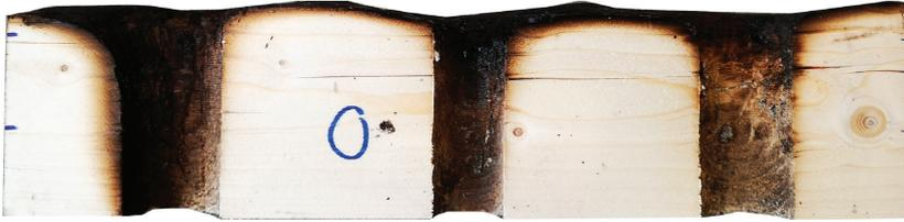
Abb. 7.3: Beispielhafte Darstellung eines Schnittes nach dem Brandversuch durch Bohrungen eines Probekörpers
