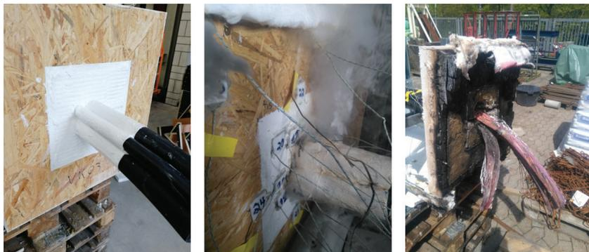
Abb. 6.4: Weichschottsystem vor, während und nach dem Brandversuch
