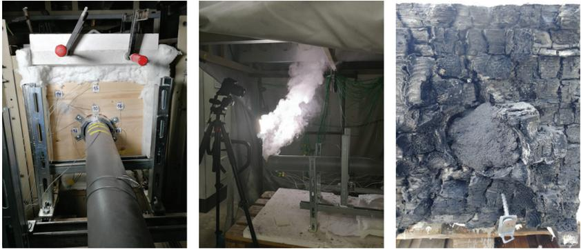
Abb. 6.6: Rohrmanschette vor, während und nach dem Brandversuch
